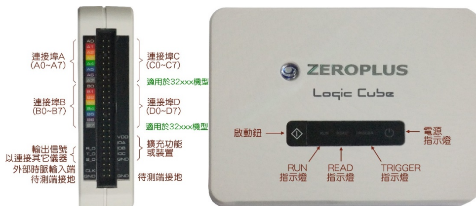
▲圖 2-2-1 LAP-C16128 邏輯分析儀之側面(左)與正面(右)
