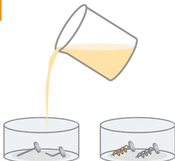
在洋菜粉溶液中加入 10 滴 0.1M 赤血鹽溶液、5 滴酚酞指示劑及少許食鹽攪拌之，靜置備用。
