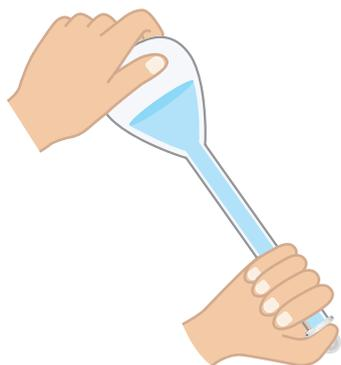
加水至定量瓶標線，蓋上瓶塞倒置搖勻後備用。
