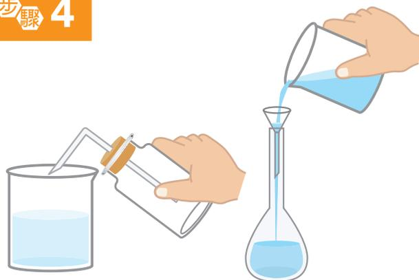
以少量蒸餾水淋洗燒杯後注入量瓶中，重複數次。
