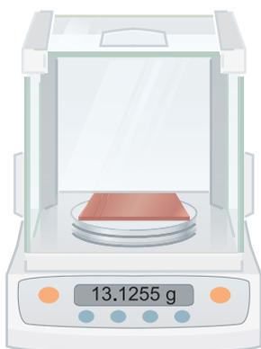
取 2 個銅片以砂紙磨光，再清洗表面污垢，乾燥後取 1 片精稱重量並記錄。
