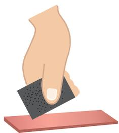
取一個銅片、鋅片、鎳片與碳棒用砂紙磨光表面後，以去離子水洗淨備用。
