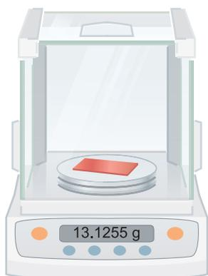
取 4 個銅片以砂紙磨光，再清洗表面污垢，乾燥後取 2 片精稱重量並記錄，編號 A、B。
