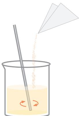
將洋菜粉倒入燒杯並不斷攪拌使其完全溶解，若無法完全溶解，則再加熱及攪拌。
