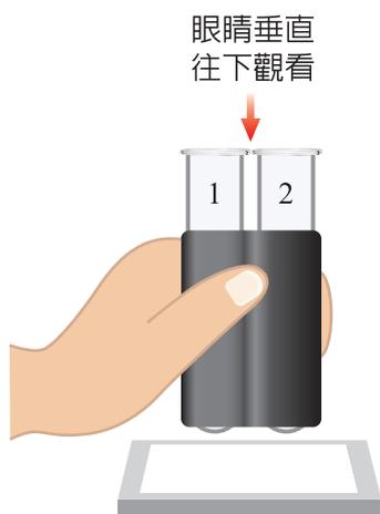
以 1 號比色管做為標準溶液，先將 2 號比色管取出與 1 號比色管並排握住，並以黑紙包住比色管，將 2 支比色管放在比色裝置上比色，然後由試管口上端垂直往下觀察。
