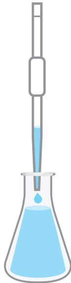
以移液管吸取前一實驗之濾液 ( 即草酸鎂飽和溶液 )50 mL 置於錐形瓶中。
