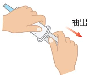
取乾淨注射筒 1 支，抽取空氣 10 mL，以預先挖好凹槽的橡皮塞封住注射筒頭端，以標籤註明 B。
