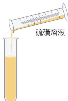
加入 1 mL 硫磺溶液的澄清液並搖晃試管使其均勻混合，製成硫磺膠體溶液。
