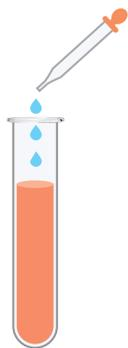
於各試管中分別加入 10 滴之 0.1 M NaCl、0.1 M CaCl<sub>2</sub> 與 0.1 M Na<sub>2</sub>SO<sub>4</sub>，充分搖盪後靜置，觀察其結果。
