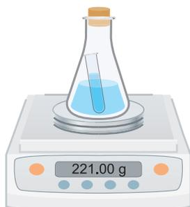
將錐形瓶口塞入橡皮塞，稱量錐形瓶重並記錄為  $W_0$ 。
