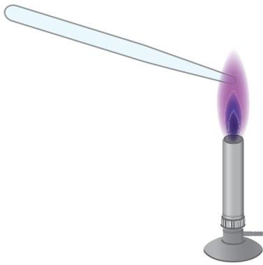
滴管小口徑端於火焰中燒至平滑並調整截面至滴水 20 滴恰為 1 mL。
